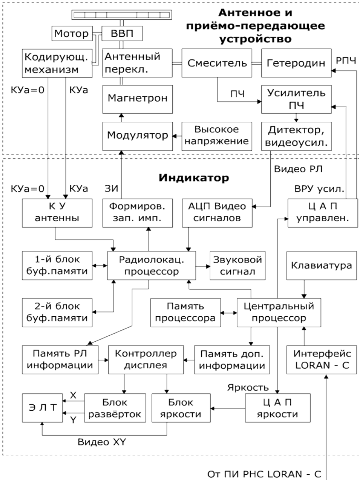
Рис.1 Функциональная схема РЛС JMA-2044
